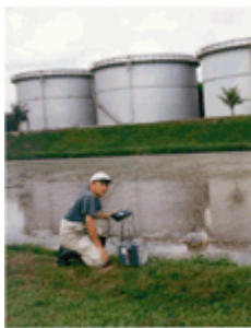
マレーシア・FELDA 社 Serting Hilir 工場の廃液処理池から放出されるメタンガス量の測定
