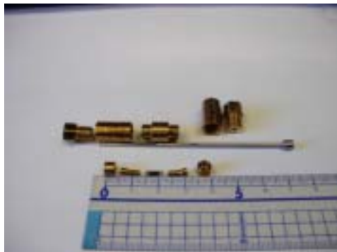
図 1. 新型ピストンシリンダー型高圧力発生装置 (九工大と(株)HMD の共同開発)
