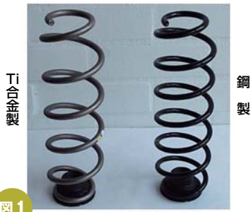
図1 自動車用サスペンションスプリングコイル。チタン合金製を採用することにより、コイルは大幅に軽くなります。
